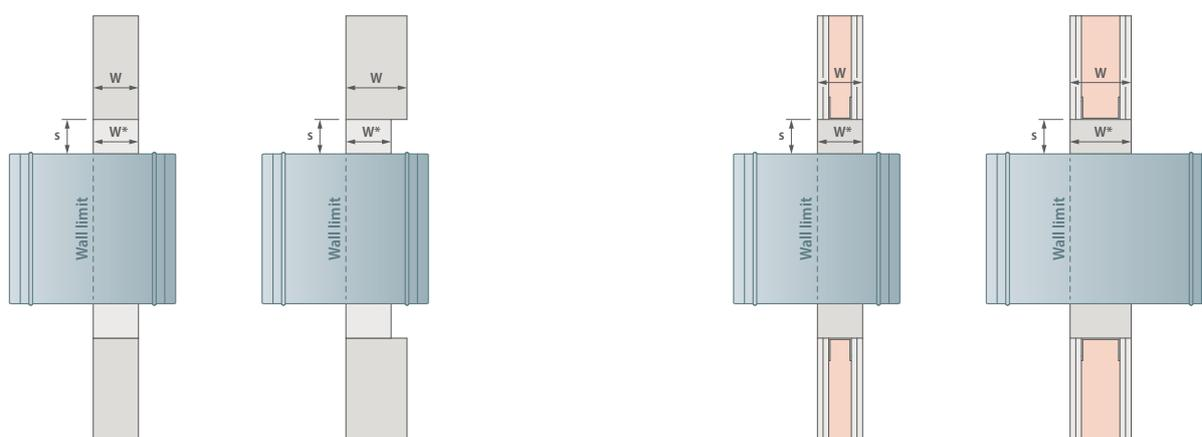
Si l'ouverture autour du clapet coupe-feu est plus grande que ce qui est indiqué dans la fiche technique, les options suivantes sont possibles : réduire la réservation dans la paroi avec le même matériau que la paroi ; appliquer un autre système d'étanchéité ; demander un autre avis auprès d'une autorité locale compétente (éventuellement en consultation avec Rf-t). Il faut toujours tenir compte de la stabilité de la paroi et du bon fonctionnement du clapet coupe-feu.
