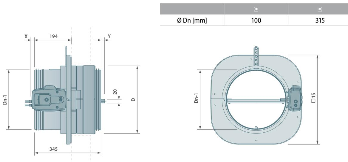
Projection de la lame : X = côté longitudinal du mécanisme, Y = côté longitudinal du mur
