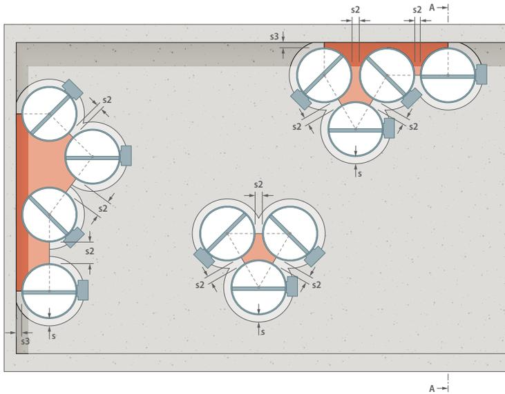
Lors de l'installation de clapets coupe-feu Rf-t à distance minimale dans une cloison légère, aucun profilé métallique ne doit être placé entre le clapet coupe-feu et la construction (porteuse) ou entre les clapets coupe-feu eux-mêmes.
