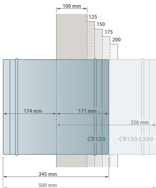
Les clapets allongés peuvent faciliter l'installation dans le cas de parois plus larges, par exemple. En fonction de la facilité d'installation, le CR120(-1S), d'une longueur standard de 345 mm, peut être remplacé par une version plus longue de 500 mm (CR120(-1S)-L500).
