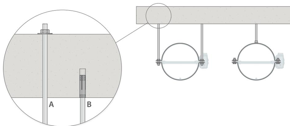
Si l'on choisit de soutenir les clapets coupe-feu, les tiges filetées dimensionnées des suspensions peuvent être fixées à travers le dalle d'une part (A). D'autre part, les tiges filetées peuvent être fixées dans le plafond à l'aide de douilles à chocs ou de vis (B) selon les indications du fabricant et en tenant compte des exigences en matière de protection contre l'incendie.
