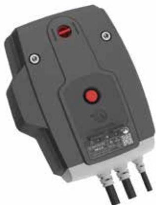
Le ONE-X est un composant unique du système ZENiX : un servomoteur de clapet coupe-feu avec un module de communication intégré ZENiX. Il est préassemblé sur le clapet coupe-feu, ne nécessite aucun adressage ou configuration et est immédiatement prêt à être connecté. Le ONE-X permet de gagner du temps lors de l'installation, de réduire les erreurs de câblage et d'économiser de l'espace.
